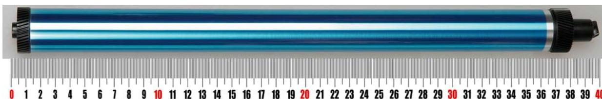
3. Покрытие на барабане прозрачное (свет отражается от алюминиевой поверхности барабана), это покрытие имеет при обычном освещении синие оттенки. Общая длина барабана 409 мм.
